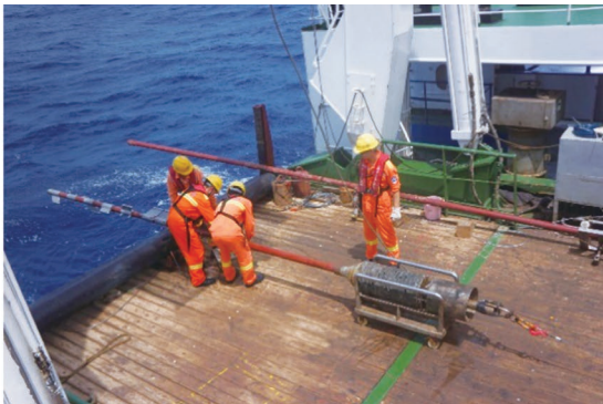
图7-12 研发的FY-1型温度测量仪
